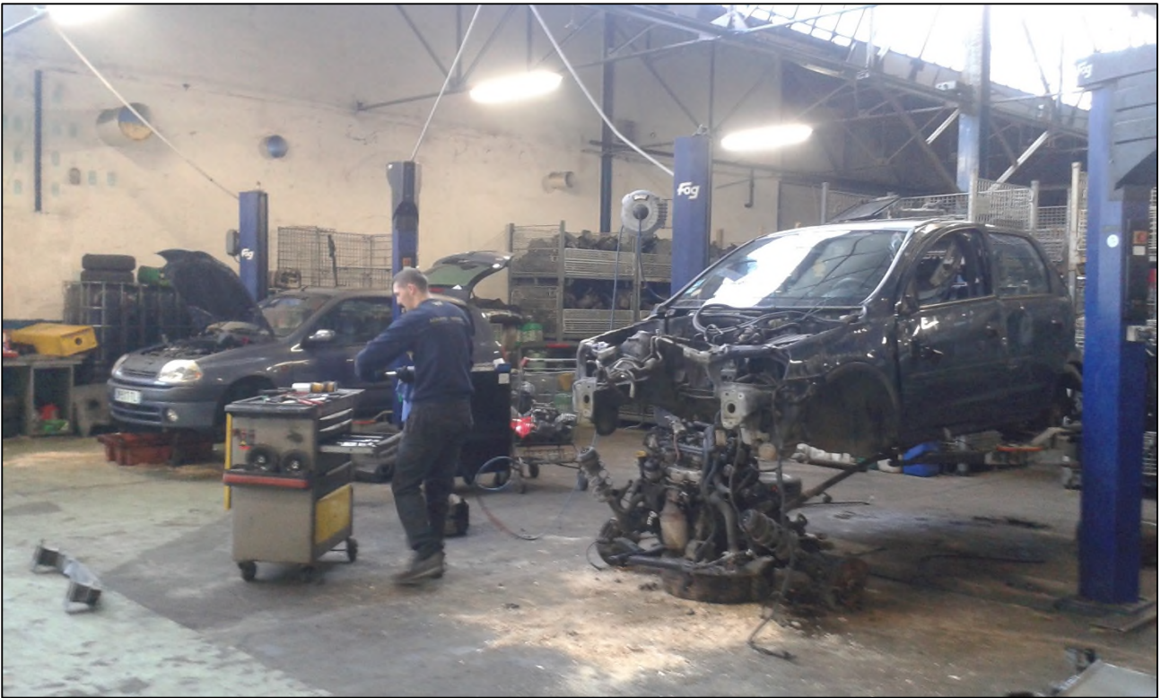
VHU en cours de dépollution et démontage
